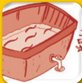
2. Quando a caixa estiver quase vazia, feche a saída e utilize a água que restou para a limpeza da caixa e para que a sujeira não desça pelo cano.
